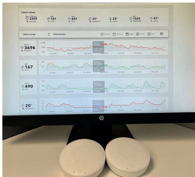
Flyttbare inneklimasensorer som måler temperatur, CO 2 , radon, fuktighet m.m. i våre leietakers lokaler.
